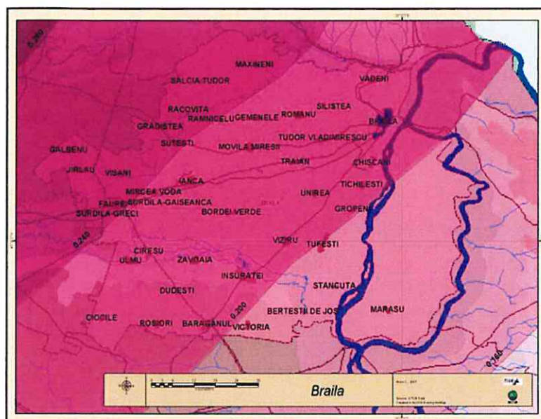
Valoarea de vârf a accelerației terenului pentru proiectare ag pentru cutremure având intervalul mediu de recurență IMR = 100 ani (reprezentarea județului Brăila)
